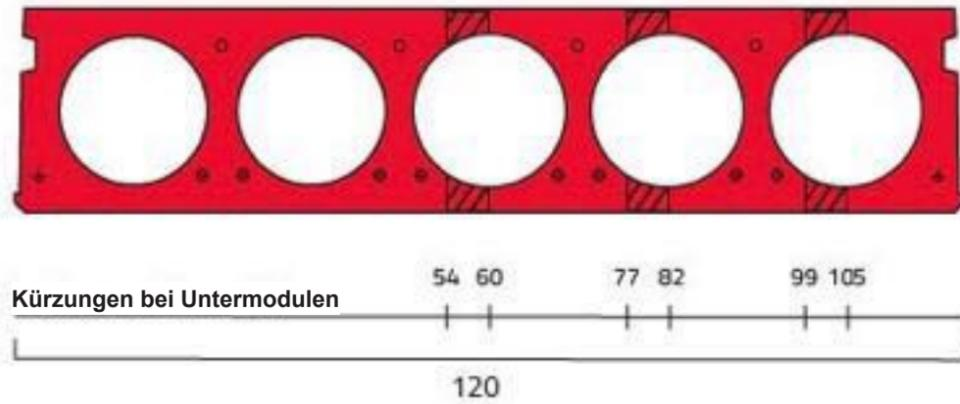
Für Decken nicht für Bedachung: Grenzwert Licht max/Dicke  $<(35+20\%)= 42$  [mit Dicke=Deckenhöhe + (Plattenhöhe/2)] CNR10025/89
