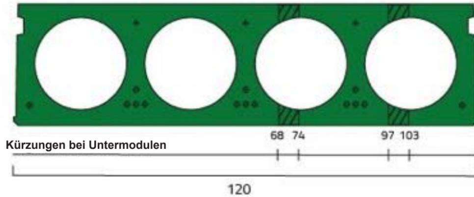
Für Decken nicht für Bedachung: Grenzwert Licht max/Dicke  $<(35+20\%)=42$  [mit Dicke=Deckenhöhe + (Plattenhöhe/2)] CNR10025/89
