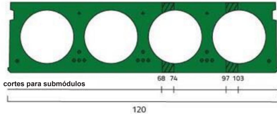
Para losas sin cubierta: límite Luz máx/espesor  $<(35+20\%)= 42$ [con espesor= altura de losa + (altura de losa/2)] CNR10025/89
