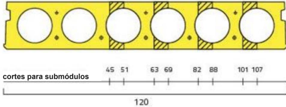
Para losas sin cubierta: límite Luz máx/espesor  $<(35+20\%)= 42$ [con espesor= altura de losa + (altura de losa/2)] CNR10025/89
