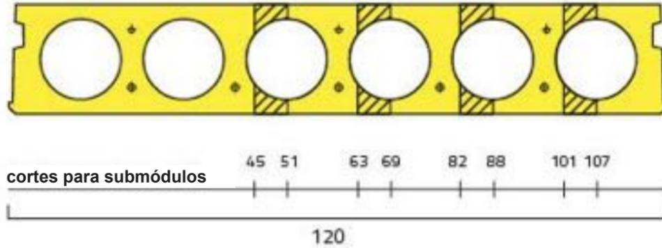
Para losas sin cubierta: límite Luz/espesor máx.  $<(35+20\%)= 42$ [con espesor= altura losa + (altura losa/2)] CNR10025/89 La capacidad portante se entiende neta del peso propio de la losa y del peso propio de la losa colocada. Todas las gamas permiten declarar un índice de resistencia al fuego de R90.
