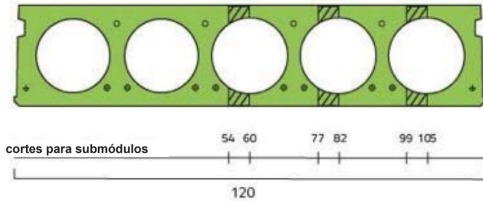
Para losas sin cubierta: límite Luz máx/espesor  $<(35+20\%)= 42$ [con espesor= altura de losa + (altura de losa/2)] CNR10025/89
